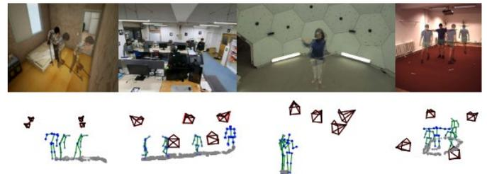
図1: 人物の動きを用いた自動カメラキャリブレーションによるマーカースレスモーションキャプチャ
